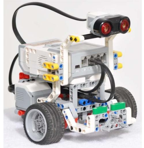
Notre configuration comporte, la batterie, deux gros moteurs, un capteur de couleur et un capteur à ultrasons.
